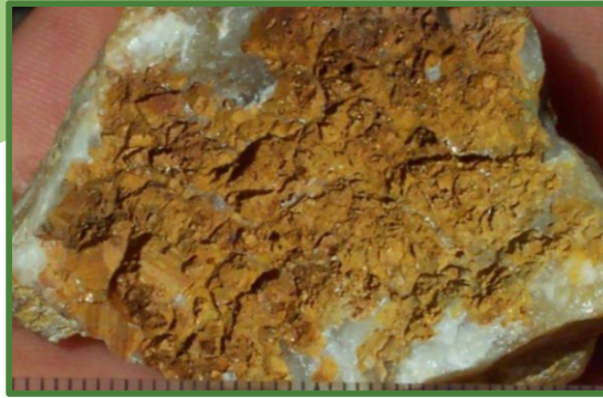
Vetillas de cuarzo con presencia de oro libre en cavidades (Quartz veinlets with presence free gold in cavities)
