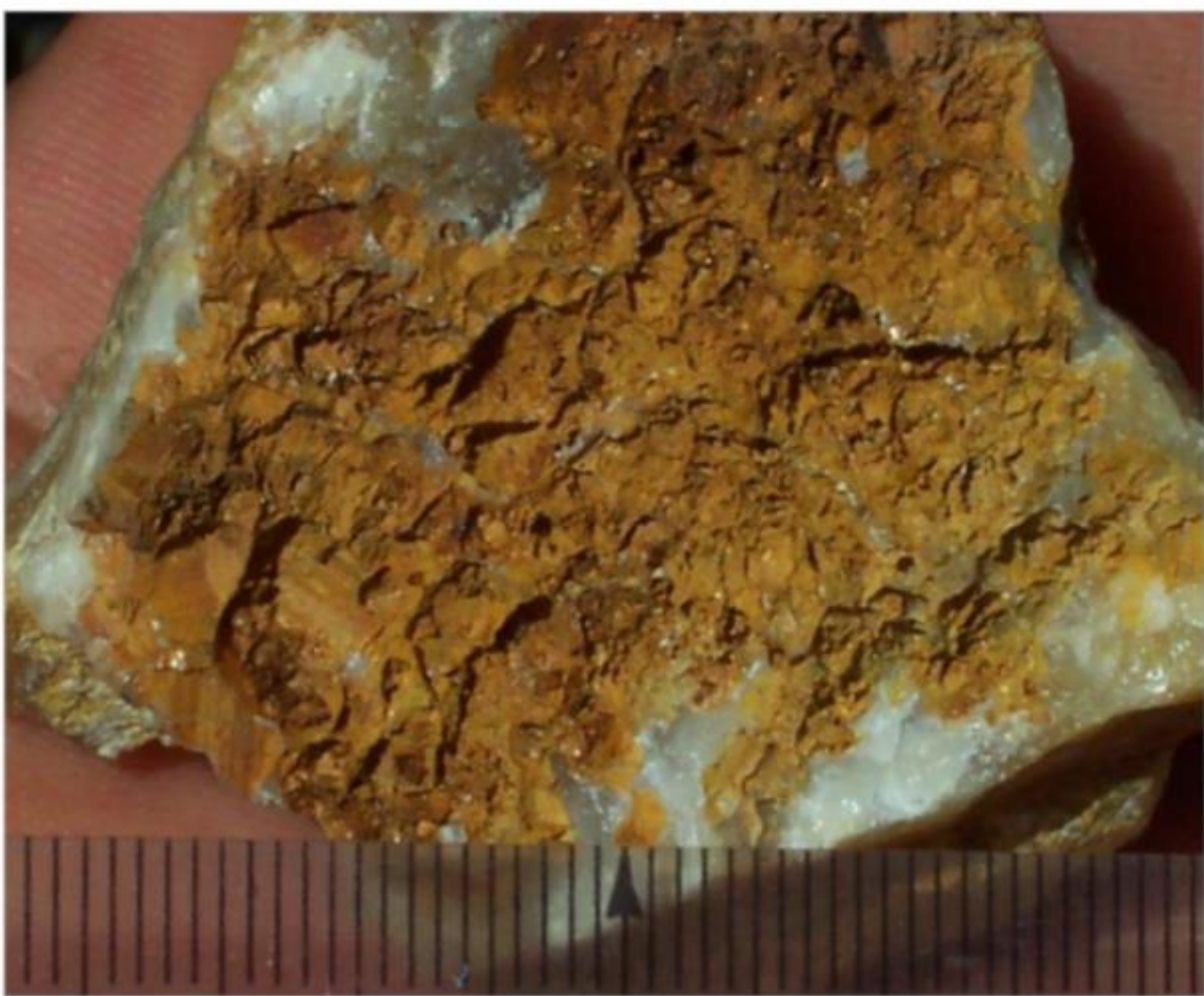
Figura N° 78: zona El Cura: Vetillas de cuarzo con presencia de óxidos de limonitas, jarosita y oro libre en cavidades.
