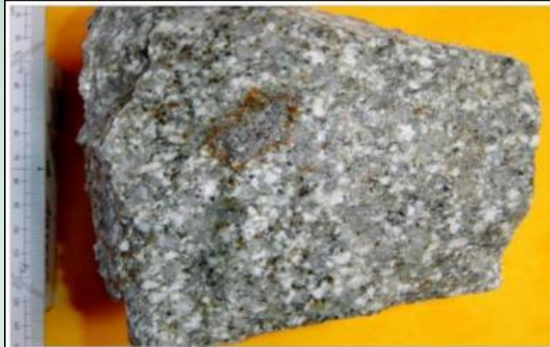
Figura N° 28: zona El Cura: Tonalita porfírica: plagioclasas 60%, en partes sericitizadas, cuarzo 25%, biotitas 10% reemplazada por cloritas, ferromagnesianos reemplazados por epidota, calcita, alteración propilítica.
