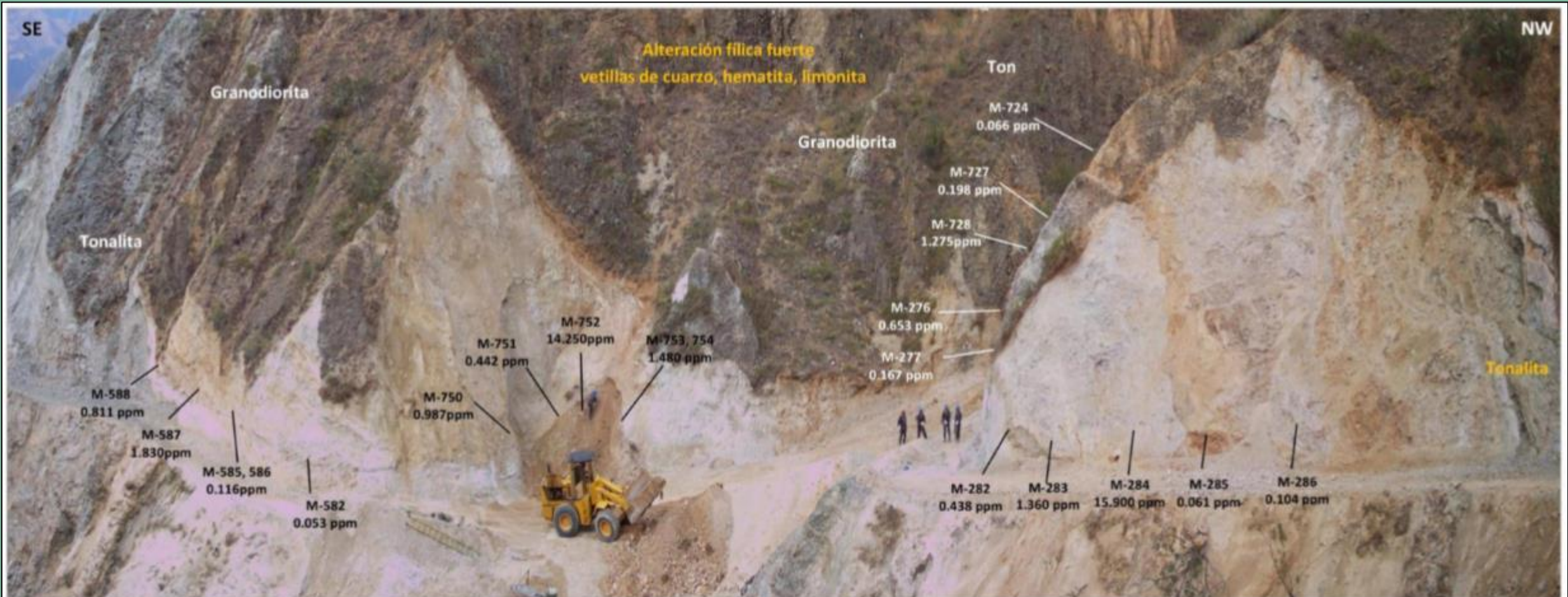
Figura N° 86: Norte 9101800 / Este 238600, altitud 2,985 m.s.n.m. (Vista panorámica hacia el norte 240°): Nivel intermedio de la zona El Cura, zona con fuerte alteración cuarzo-sericita y vetillas polidireccionales de cuarzo, hematita, goethita y limonita 08%, en brechas granodioritas brechadas a craqueladas.
